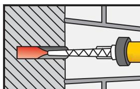
L'injection se fait en partant du fond tout en reculant progressivement la buse de mélange. Veiller à éviter les inclusions d'air dans la résine. Pour les trous profonds, un tube-rallonge peut être utilisé.
