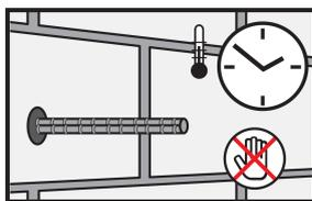
Pendant le temps de durcissement, l'ancrage ne doit en aucun cas être bougé ni mis en charge. Le positionner et le maintenir si nécessaire avec un dispositif approprié.
