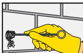
Effectuer le broissage à l'aide d'une brosse spéciale adaptée au diamètre du trou pour éliminer les particules de poussière ; le diamètre de la brosse doit être plus grand que le diamètre du trou.
